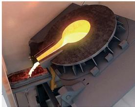
◆ 炉嘴的设计确保定点出钢, 减少钢水在流槽中落点的移动, 减少钢水飞溅。
