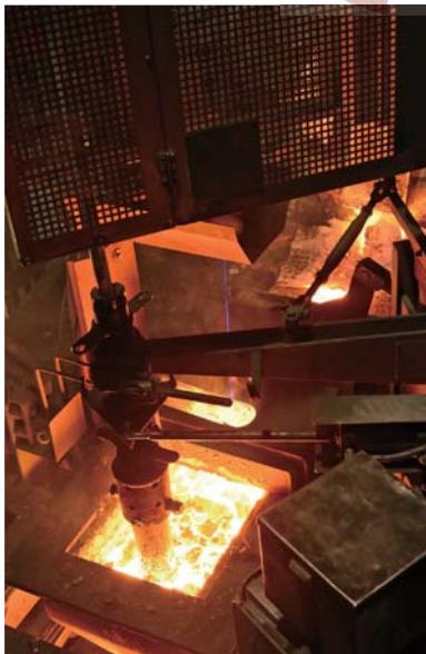
带有水冷套的浇注槽液面测量激光
