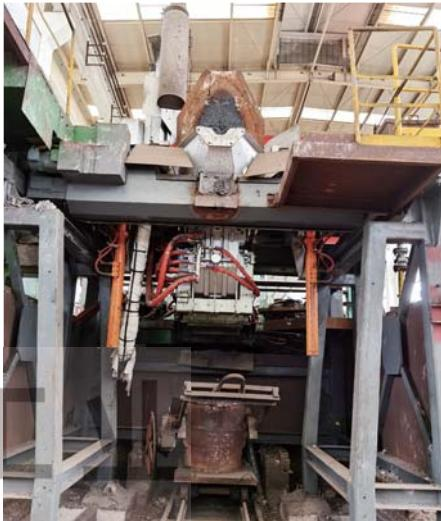
根据不同的应用场景，我们也可以提供有加热浇注机，配备感应加热电源及加热线圈，系统能够提供200KW保温功率，确保浇注时铁水温度恒定。
